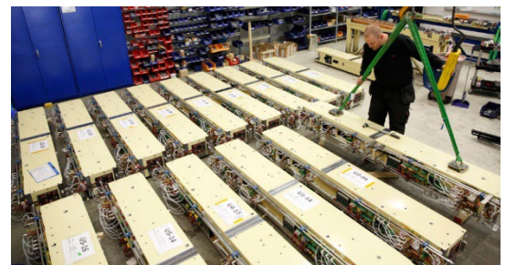
製造途中のマグネットシステム(MAX-IV向け)
